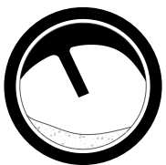
Şekil D/Buhar Kaçağı
